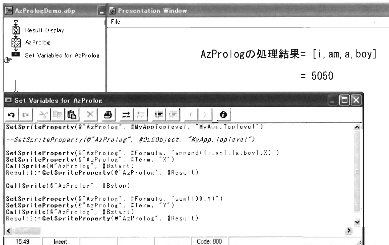
図5. 左上はAuthorwareプログラム、下がCalculationアイコン部のスクリプト、右上が実行結果。
