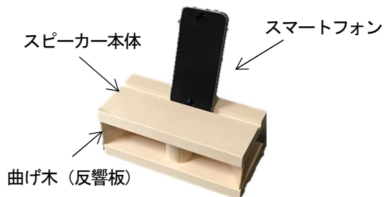
図3 ホーンスピーカー教材の外観
