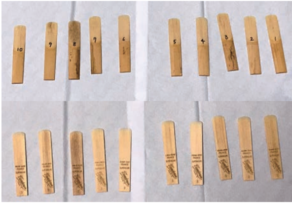
写真5 VCVによる加熱減圧処理後のリード
