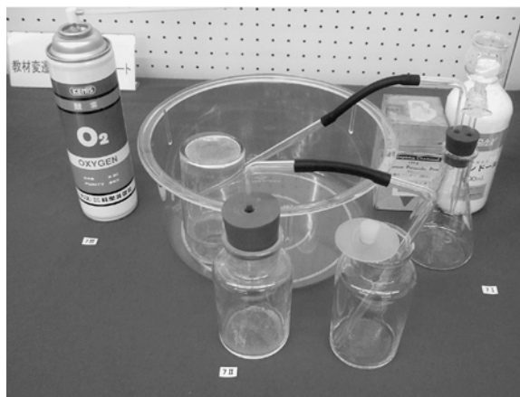
図8 酸素の発生器の移り変わり
