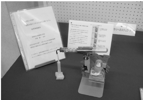
図9 (上) 気体の膨張変化を調べる器具 図10 (下) ビー玉式スターリングエンジン
