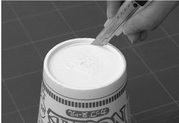
【写真-2】 容器の底を缶詰を開ける要領で切り抜く
