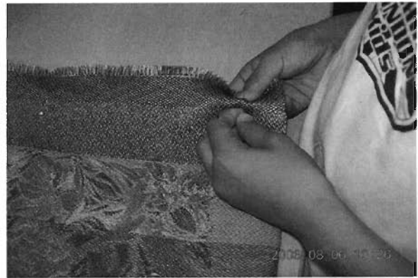
図6 工程③上下の縫い代を待ち針で留める
