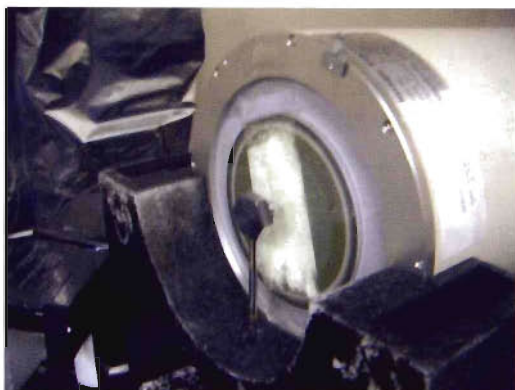
写真.8-1 シンチレータ、 \alpha 線源を設置した様子
