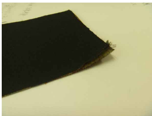
図 9 接着芯が剥離した状態
