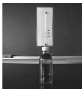
【図10】棒温度計のモデル
