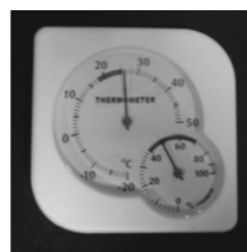
【図12】バイメタル式温度計
