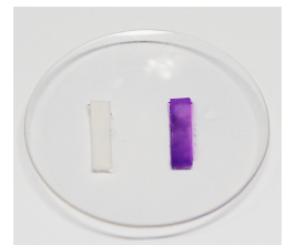
写真2 マルトース試験紙と糖化反応液による呈色
