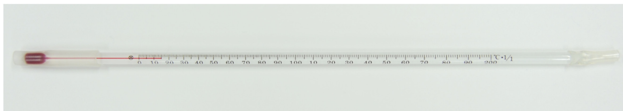
写真1 アルコール温度計から作成したかきまぜ棒。両端をシリコンチューブで保護（温度計の100℃要確認）
