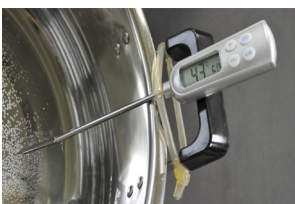
図3 温度計の固定
