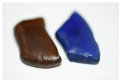
写真10 失透したガラス
