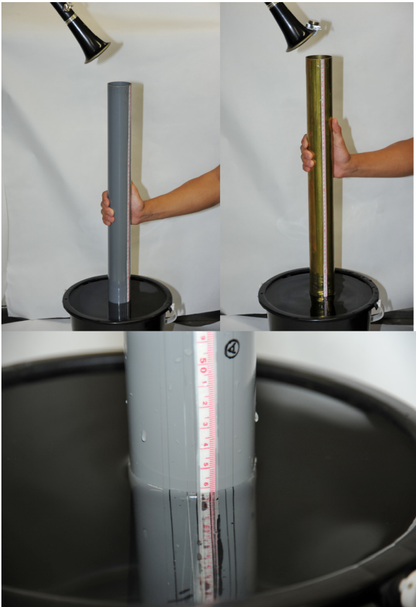
写真3 クラリネットによる気柱共鳴実験
