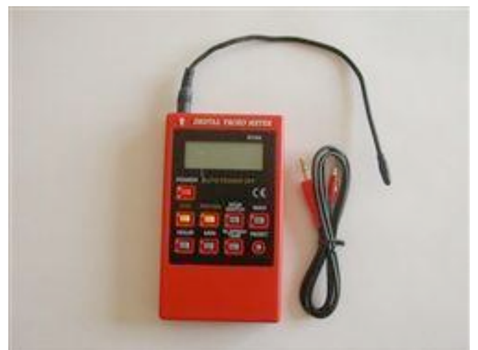
図5 非接触型回転数測定装置
