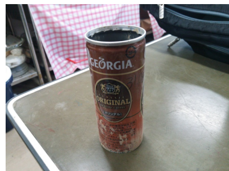
図9 作成した採土管
