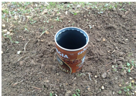
図 10 採土管を土壌に差し込んでの測定の様子
