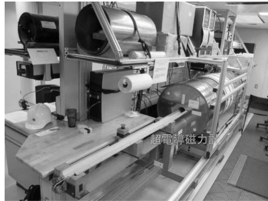
写真 2. 船内実験室のパススルー型超電導磁力計 (2G Enterprises model 760-R)。半割コアの残留磁化測定と交流消磁が可能。
