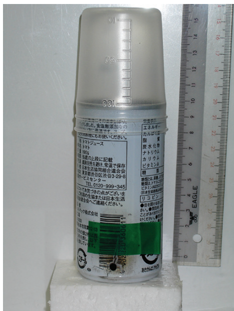
写真2 ロケット。ただし、ビニールテープは点火用の穴のすぐ上に貼ってある。
