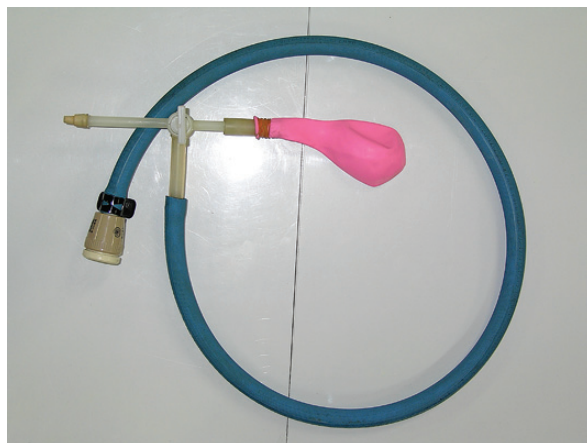
写真 4 ガス充填用アダプタ.
