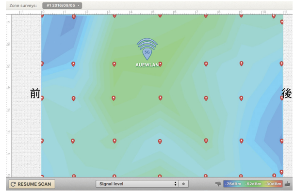
図11：2016/9/5の306教室の前方AP 36ch (5GHz)のヒートマップ
