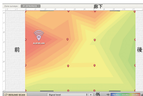
図8：2016/6/2の314教室の前廊下側AP124ch(5GHz)のヒートマップ
