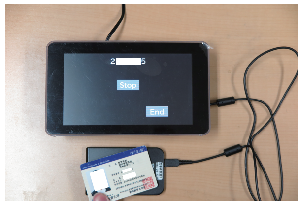
図 1: 小型ボードコンピュータによる学生証出席管理システム
