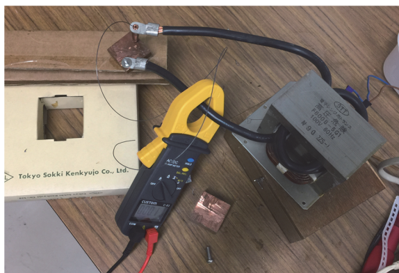
図7 溶接電圧・電流測定の概要
