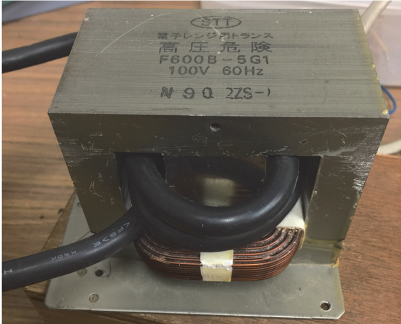
図1. 本研究で改造した電子レンジ用トランス
