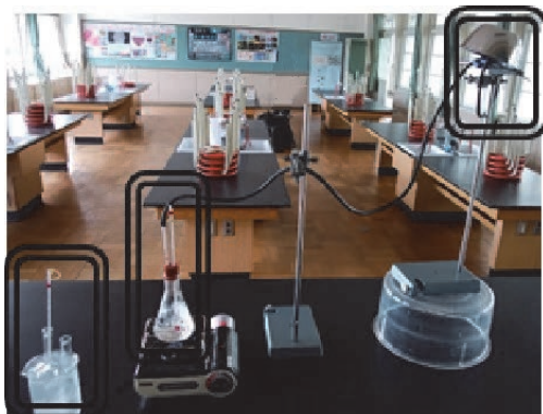
図3 水の事件現場(左端:水を凍らせる、中央:蒸発、右端:水蒸気を冷やして水に戻す装置)
