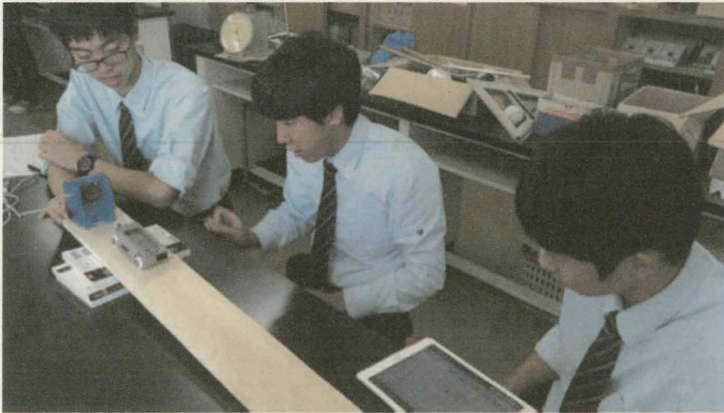
写真1 台車の運動を距離センサで計測
