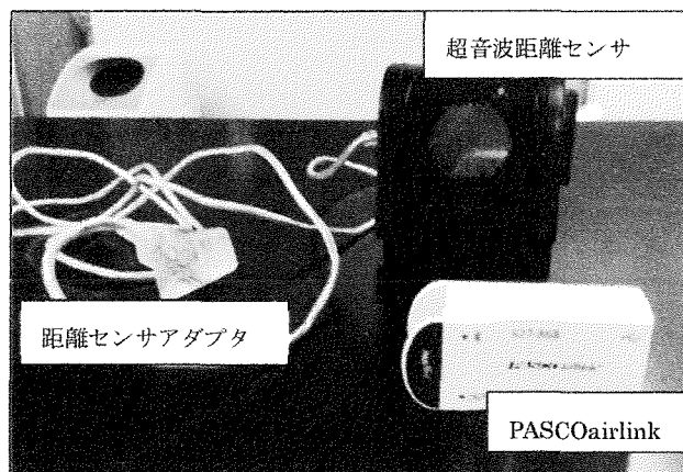
図3 超音波距離センサと接続機器
