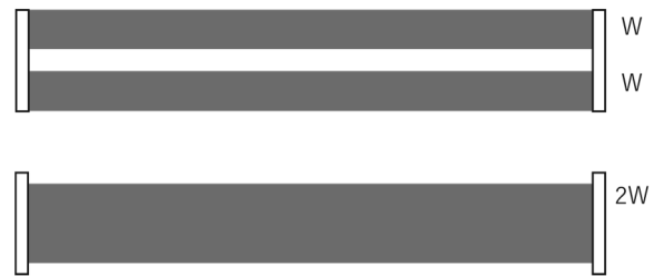
図12 カーボン・ペーパーで示した、2つの同じ抵抗を並列に接続した場合の合成抵抗
