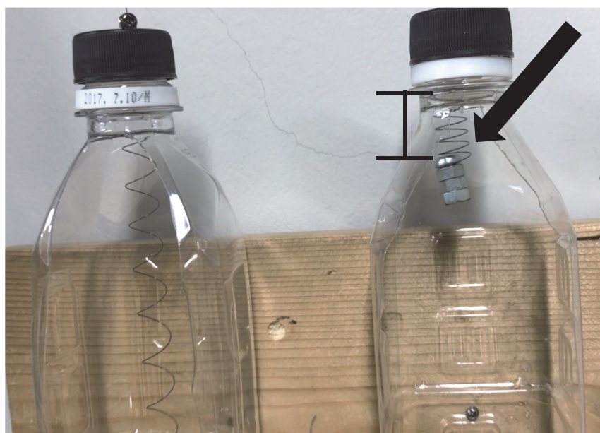
図6. 超弾性特性バネを室温からヘアドライヤーで加熱を行った時の教材の概要
