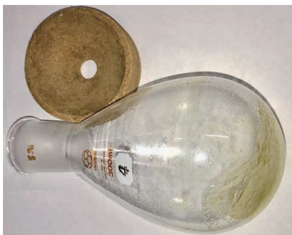
写真10 硝化綿を保存してあったEtOHの減圧濃縮乾燥で得られたEtOH可溶物の残さ。
