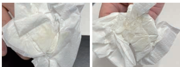
写真9 調製，乾燥後，EtOH/Et 2 O（1/2）で洗浄して乾燥した硝化綿の燃焼。よくほぐしたもの（左），及びそのまま丸めたもの（右）の燃え残りを拭いたキッチンペーパー。
