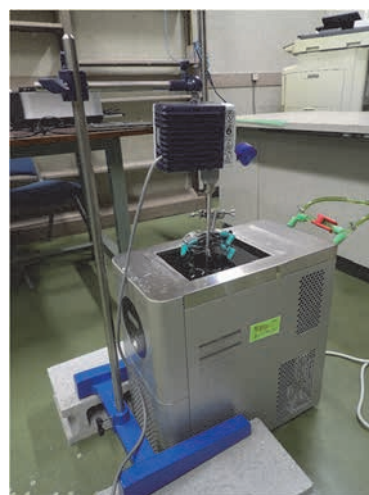
図7 ポリケイ皮酸ビニルの合成に用いた装置 (反応溶液の冷却装置と攪拌装置)
