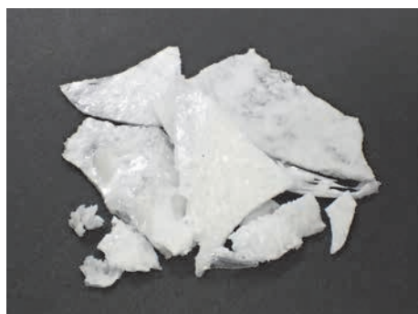
図12 乾燥後のポリケイ皮酸ビニル試料 (PVA40aから得た試料)
