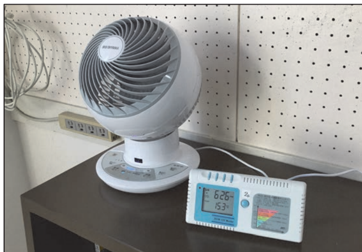
図7 サーキュレーターとCO2濃度測定モニター
