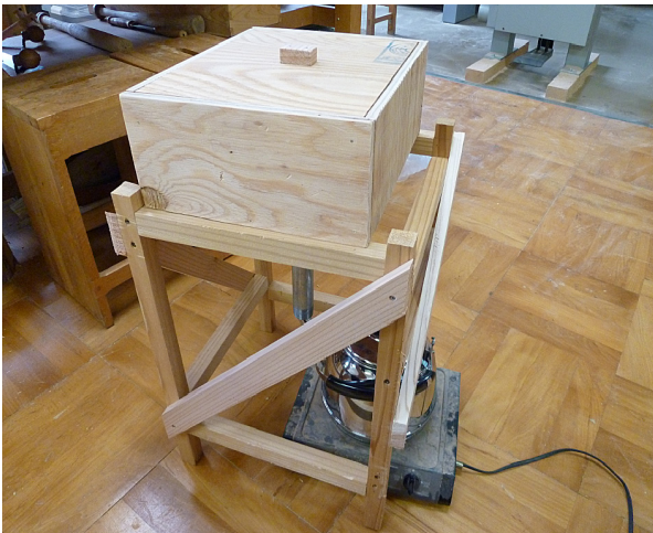
写真2 製作したスチームベンディング装置
