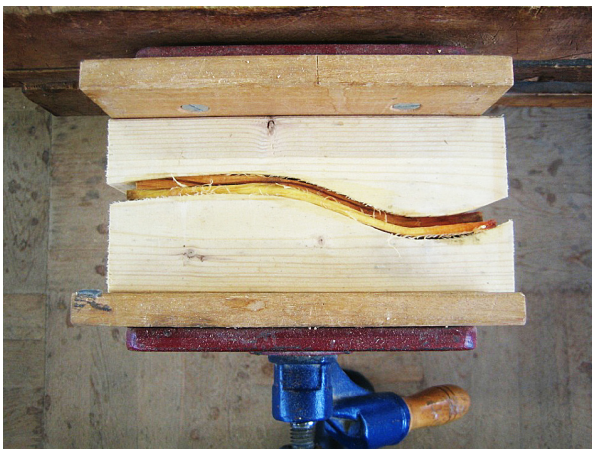
写真6 木曲げおよび乾燥の様子
