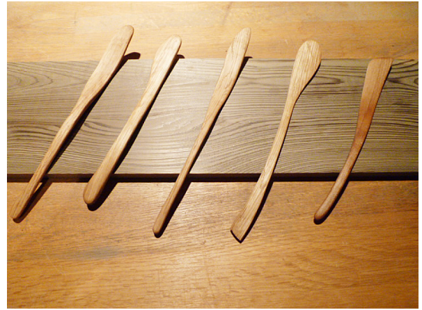
写真8 曲げ木加工した材料による試作品
