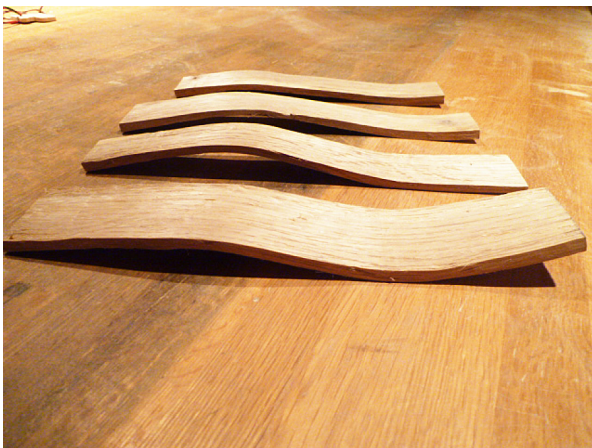
写真7 曲げ木加工したバターナイフ材料
