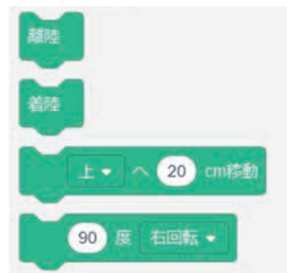
図5 ドローン制御用ブロック
