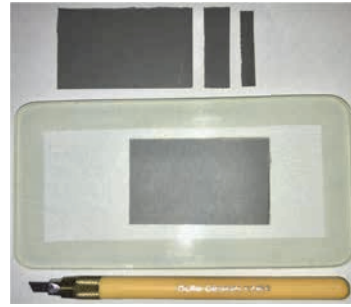
図7 ガラス板，耐水ペーパー，替刃特専黒ロング02を取り付けたデザインナイフ
