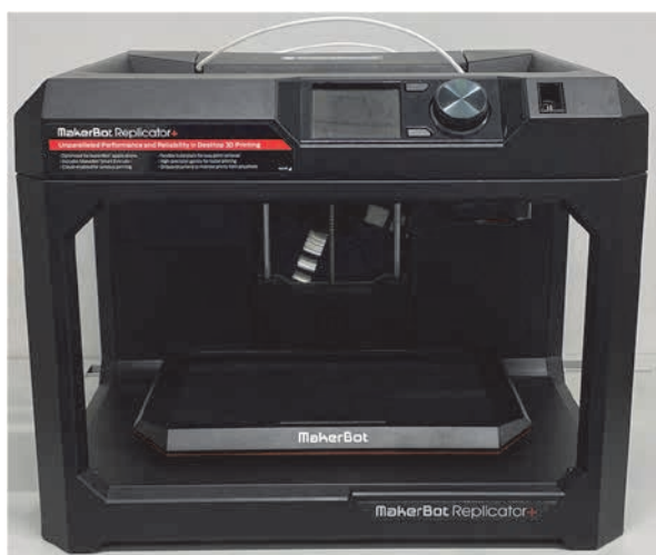
図3 今回部品作製に用いた3Dプリンタ
