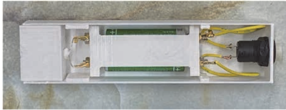
図 14 底面部品に LED 部品と電池ボックスを配置
