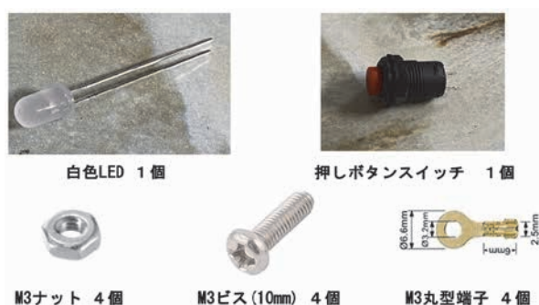
図4 LEDライトに用いた部品
