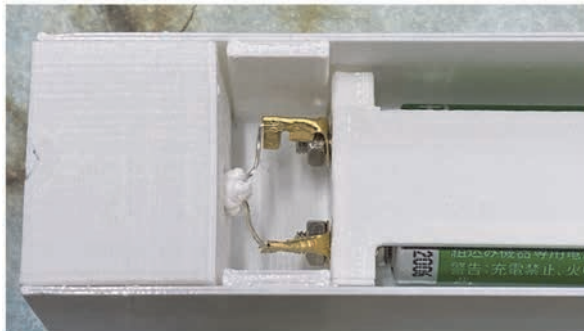
図10 底面部品へのLED部品と電池ボックスの配置
