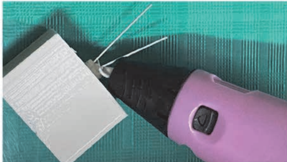
図8 ライト部品へのLEDの取り付け
