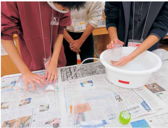
図4 水上置換法で気体を集めている様子
